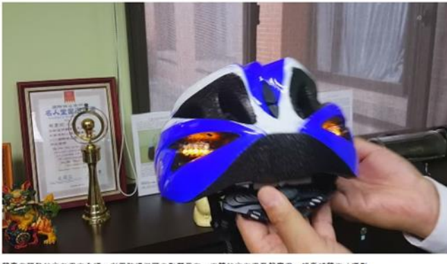
蔡彥欣研發的方向燈安全帽，利用陀螺儀可自動顯示左、右轉的方向燈及煞車燈，記者胡雅生/攝影
